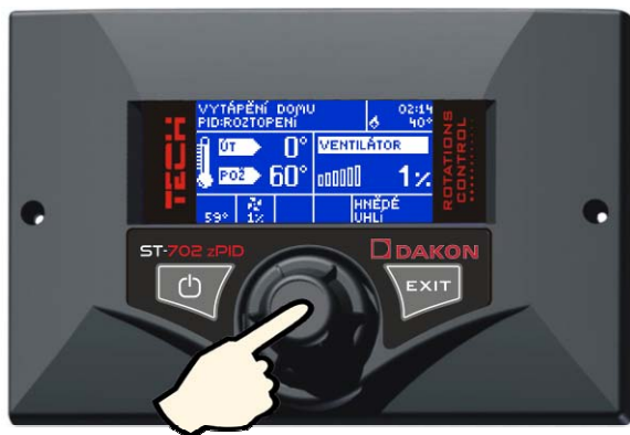
Obr. 12 Potvrzení hodnot/výběru stiskem otočného spínače
